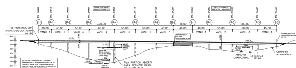
Figura 3. Alzado viaductos sobre el arroyo de Zabaleta y sobre el arroyo de Larrazábal. Proyecto licitado
