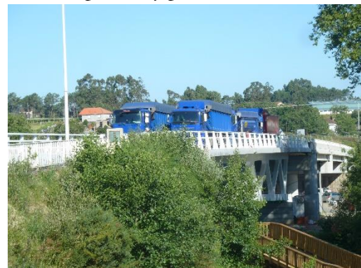
Figura 20. Prueba de carga.
