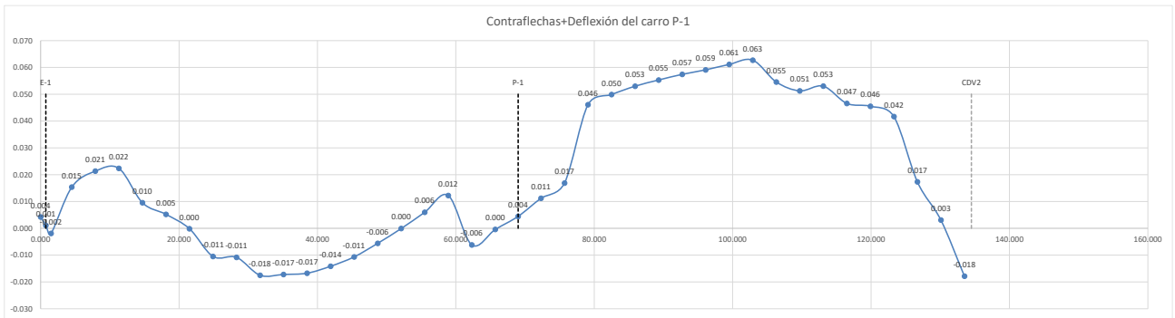
Figura 8. Contraflechas teóricas de construcción de voladizo 1
